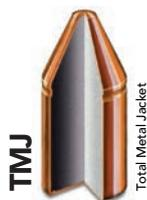
Bala con chaqueta metálica integral que no deja plomo al descubierto. A diferencia de la bala FMJ, la base también está cubierta por la chaqueta. Esto evita la vaporización del plomo al disparar. Perfecta para disparo en interior.
